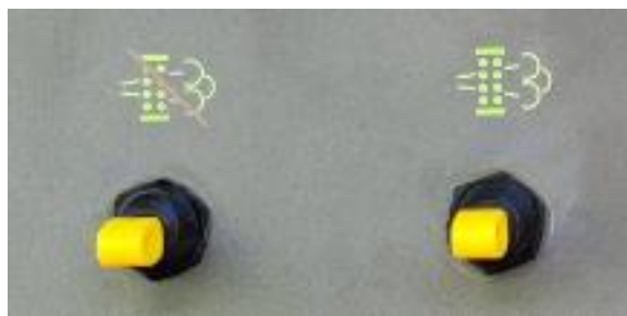
Rys. 5-17 Przycisk zakazu regeneracji i przycisk regeneracji DPF
