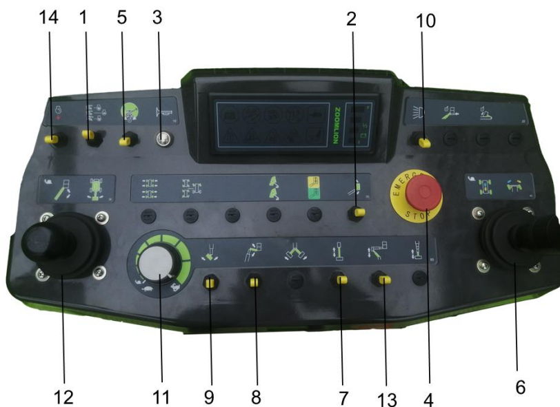
Rysunek 2-6 Panel sterowania platformą (Wskazany został jedynie numer przełącznika odpowiadający istniejącej funkcji.)
