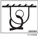
10 Punkt mocowania do podłoża
