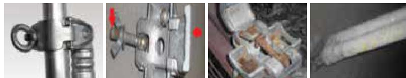
Metalowe zaciski; gumowe szczęki hamulcowe i przewody są w dobrym stanie technicznym
