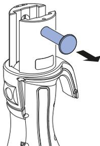
**3** Nasadte lisovací nástavec do lisovacího nástroje.
